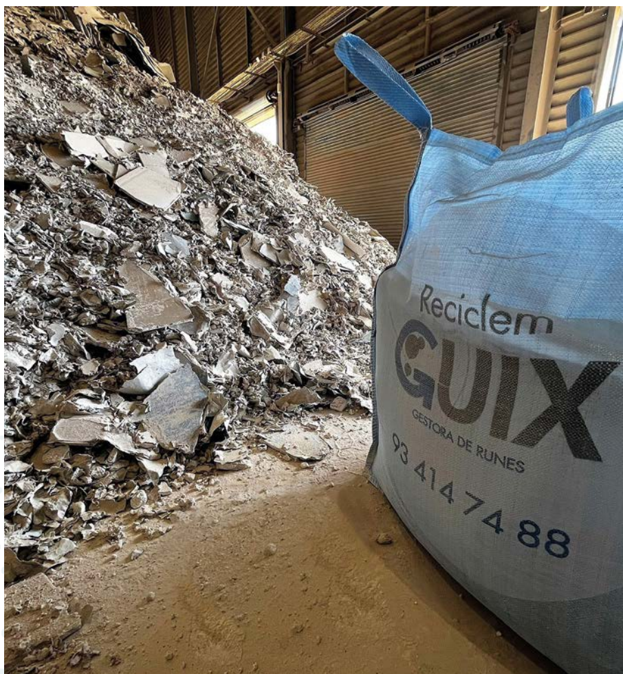
Valorització a planta de restes sobrants de plaques de guix laminat
